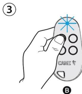
DE - Drücken Sie auf dem bereits gespeicherten Handsender die Taste, die dem Code zugeordnet ist, den Sie an den neuen Handsender senden möchten. Positionieren Sie die Handsender wie in der Abbildung gezeigt.
