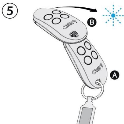
DE - Um die Batterie zu wechseln, entfernen Sie die obere Schale mit einem Schraubenzieher.
