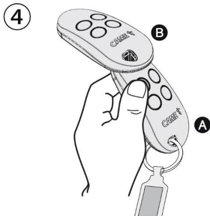
DE - Wenn das Verfahren abgeschlossen ist, wird die LED am neuen Handsender einige Sekunden langsam blinken und dann ausschalten.
