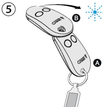
DE - Um die Batterie zu wechseln, entfernen Sie die obere Schale mit einem Schraubenzieher.
