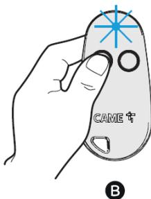
DE - Drücken Sie auf dem bereits gespeicherten Handsender die Taste, die dem Code zugeordnet ist, den Sie an den neuen Handsender senden möchten. Positionieren Sie die Handsender wie in der Abbildung gezeigt.
