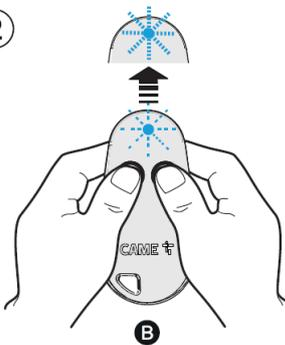
DE - Drücken Sie anschließend die zu kodierende Taste auf dem neuen Handsender. Die LED bleibt an.
